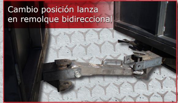
Cambio posición lanza en remolque bidireccional
