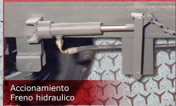
Accionamiento Freno hidraulico
