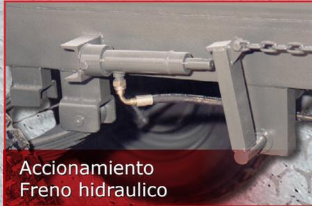
Accionamiento Freno hidraulico
