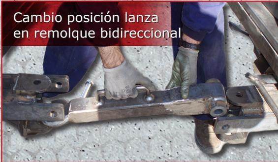
Cambio posición lanza en remolque bidireccional
