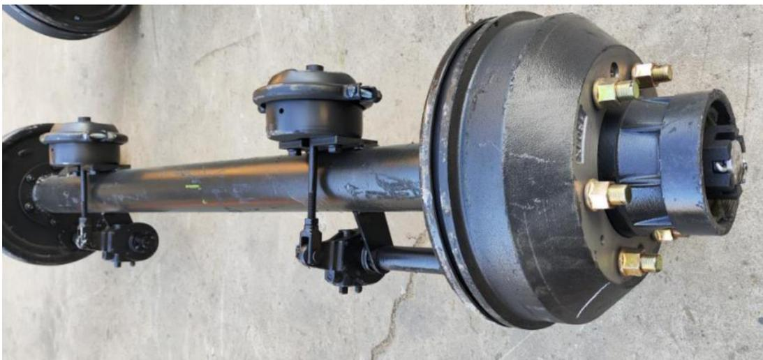
Ejes con Freno accionamiento neumatico o hidraulico que accionan las zapatas de freno dentro del tambor
